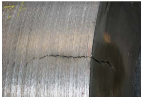
Figura 21. Grieta en tabla del cilindro.
