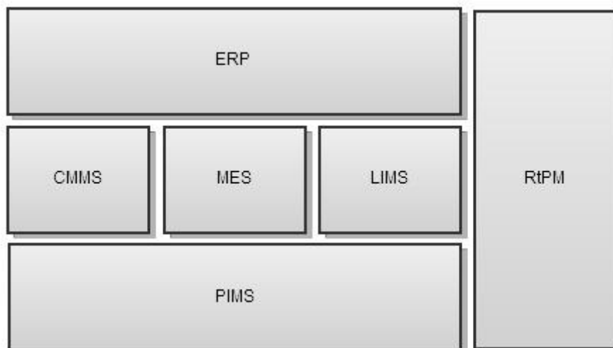
Figura 2. Arquitetura Lógica de Sistema Industrial típica.
