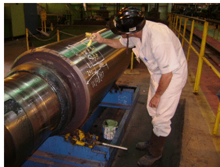
Figura 7 – Mapeamento de defeito após ensaio por ultrassom.
