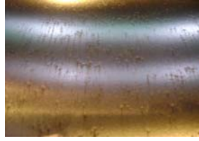
Figura 10 – Defeito superficial apresentado por alguns cilindros HSS.
