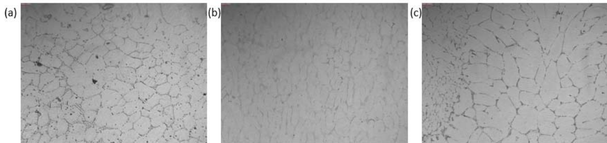
Figura 6: Imagem no microscópio óptico da liga 0,30% at Cu. (a) Região da Base. (b) Região do Centro. (c) Região do Topo. (Ataque: 14% HNO 3 - 1% HF - 85% H 2 O).
