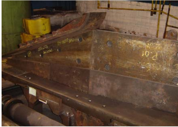
Figura 2. Guia de Entrada do LTQ Lado AC
