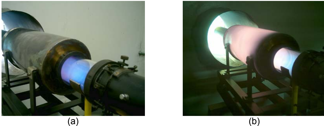
Figura 9. (a) Câmara operando sem oscilação acústica. (b) Câmara operando com oscilação acústica.
