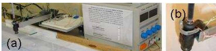
**Figura 5.** (a) Fotografia do aparato utilizado na realização dos ensaios de ejeção e (b) detalhe da válvula de injeção eletrônica acoplada a uma seringa contendo tinta corante azul.
