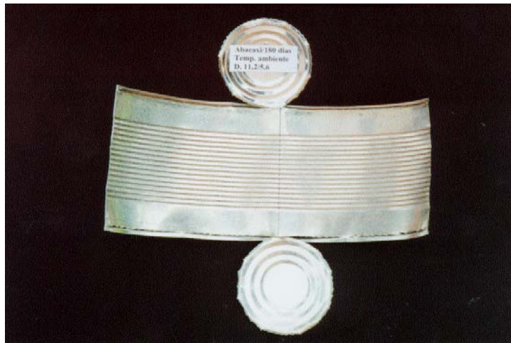
Figura 9 – Lata “branca” produzida com folha-de-flandres CSN após 180 dias de estocagem à temperatura ambiente
