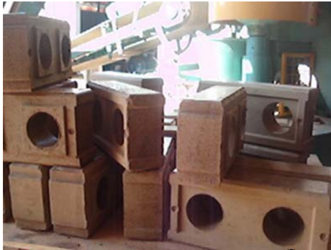
Figura 4. Blocos prensados mecanicamente. (7)
