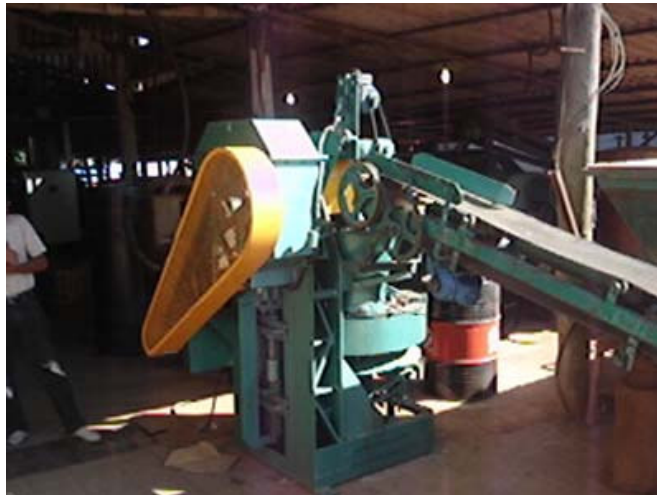
Figura 3. Prensa utilizada na confecção dos blocos. (7)
