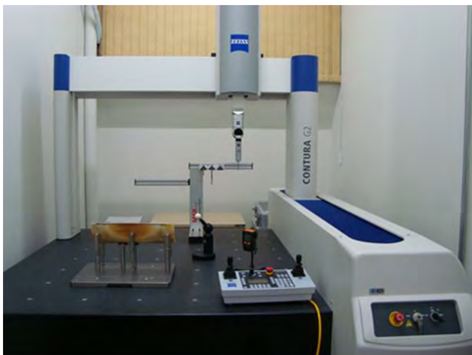
Figura 5. MMC, fabricada pela Carl Zeiss, modelo Contura G2 RDS/XXT.
