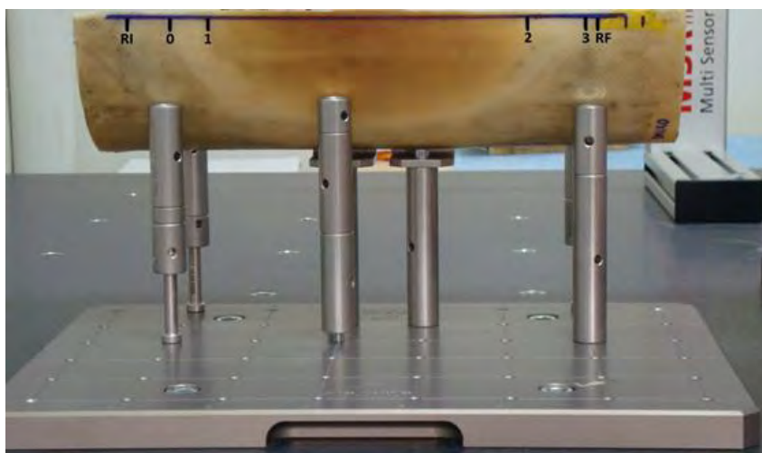
Figura 6. Regiões analisadas: de RI (referência inicial) a 0, região não desgastada superior; de 0 a 1 e de 2 a 3, as regiões desgastadas expostas à água durante o teste; de 1 a 2, região desgastada central; de 3 a RF (referência final), região não desgastada inferior.
