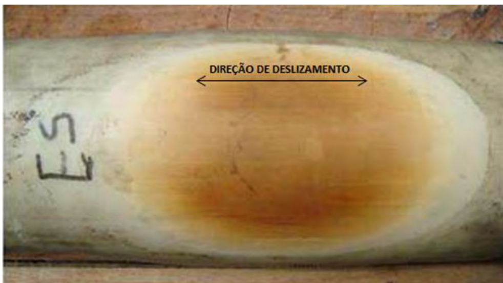
Figura 3. Amostra de um riser de 4 in (101,6 mm) de diâmetro interno desgastada no lado esquerdo, após 296 mil ciclos de ensaio. A capa polimérica é de poliamida (PA).
