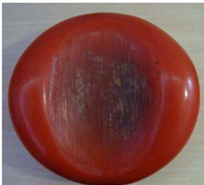
Figura 4. Amostra de um enrijecedor de 240 mm de diâmetro externo, feita de poliuretano (PU), desgastada no lado esquerdo, após 296 mil ciclos de ensaio.
