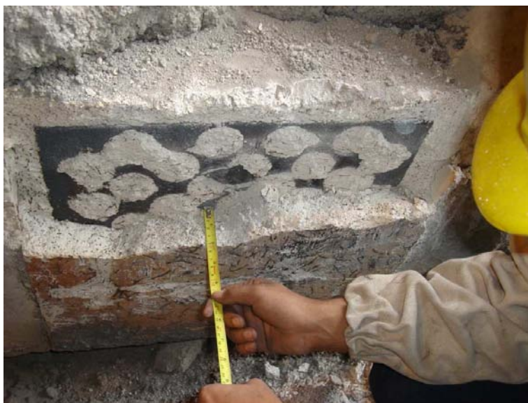
Figura 10 – Medição de residual refratário da peça modificadora de fluxo.
