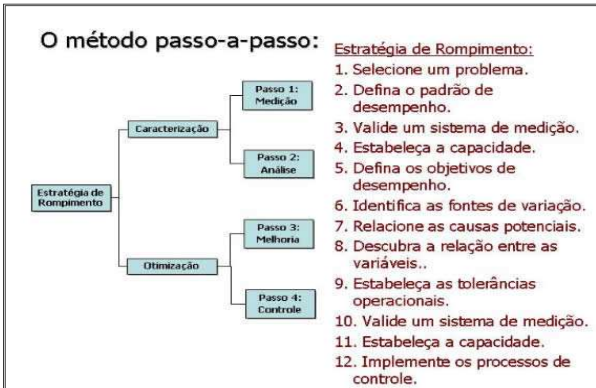
Figura 3: O método DMAIC passo a passo. (2)
