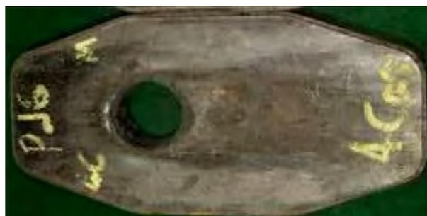
**Figura 6.** Placa Magnesian B2 após 4 corridas na Planta B.
