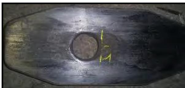
**Figura 5.** Placa Magnesian B1 após 3 corridas na Planta A.
