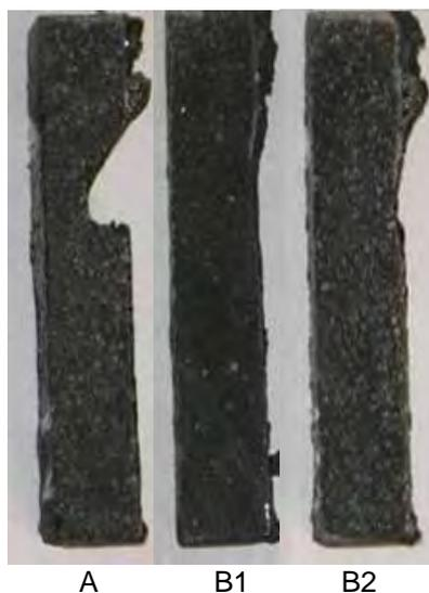
**Figura 2.** Amostras após teste de corrosão.
