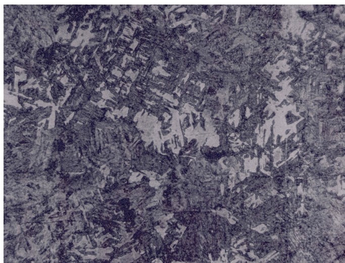
Figura 4. Microestrutura bainítica, obtida na produção de rolos austemperados, aumento :400X, ataque: Nital 1%
