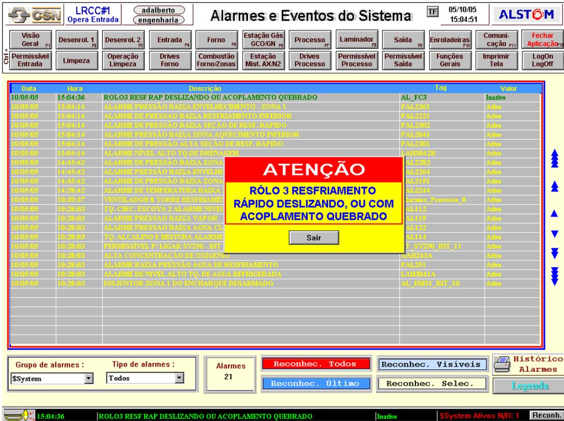
Figura 7 – Exemplo de Alarme de Rolo Deslizando ou com Acoplamento Quebrado
