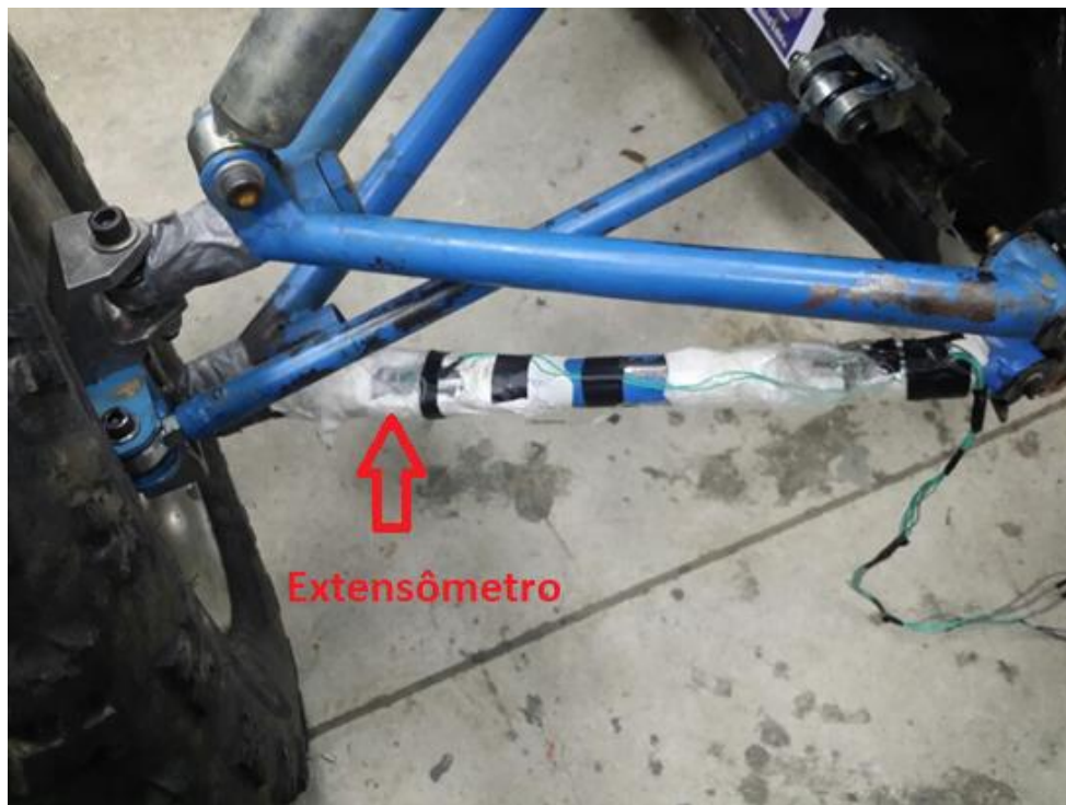
Figura 13. Foto do braço de suspensão dianteira direita inferior.
