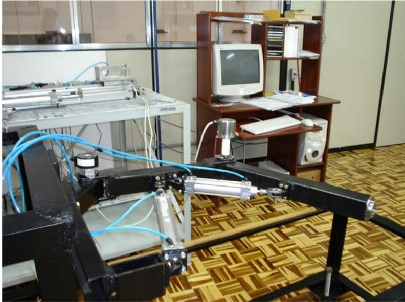
**Figura 7.** Protótipo do manipulador pneumático configurado para trabalho no plano horizontal.
