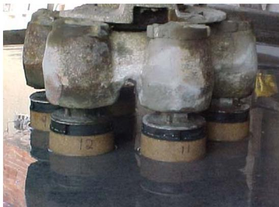
**Figura 2.** Detalhes de conjunto de 6 corôas – grupo 2 – montadas no satélite da politriz industrial, sobre a placa de granito. Cada coroa gira a 100RPM, e suporta a força de 50kgf.
