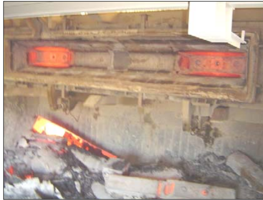
Figura 9. Resultado da retirada de cascão de aço.
