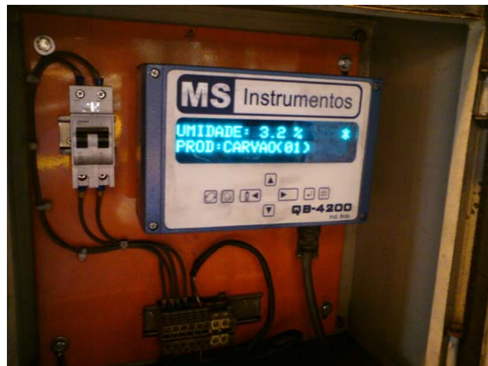
Figura 7. Display mostrando resultado de umidade de carvão vegetal naquele momento.
