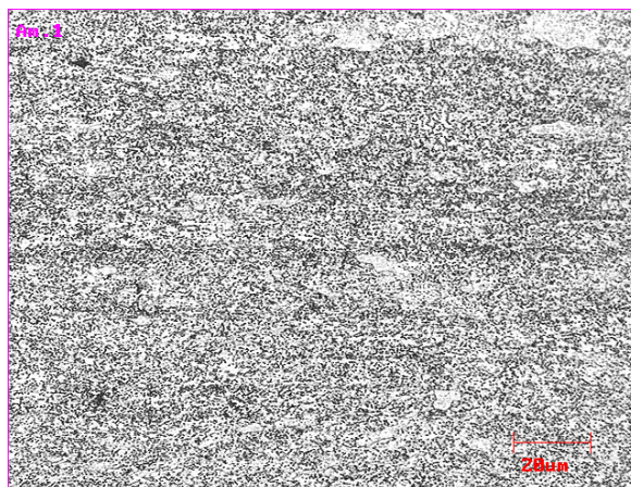
Figura 8. Microestrutura típica do aço D6A após a laminação a frio e tratamento térmico.
