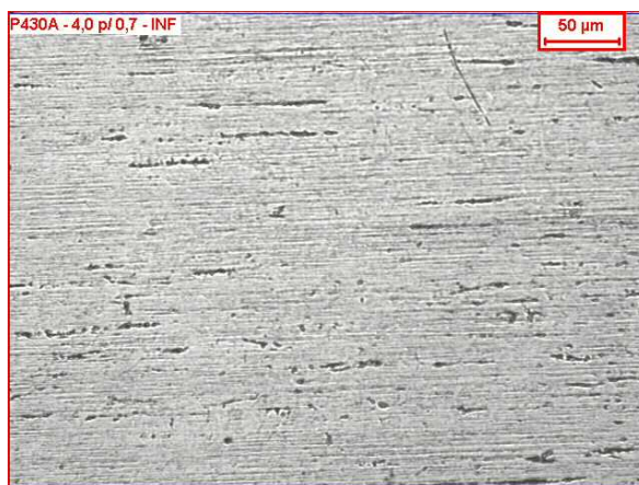
Figura 8 – Superfície de uma bobina de P430A, 0,70 mm, aprovada após ajuste da rugosidade do cilindro de laminação a frio.
