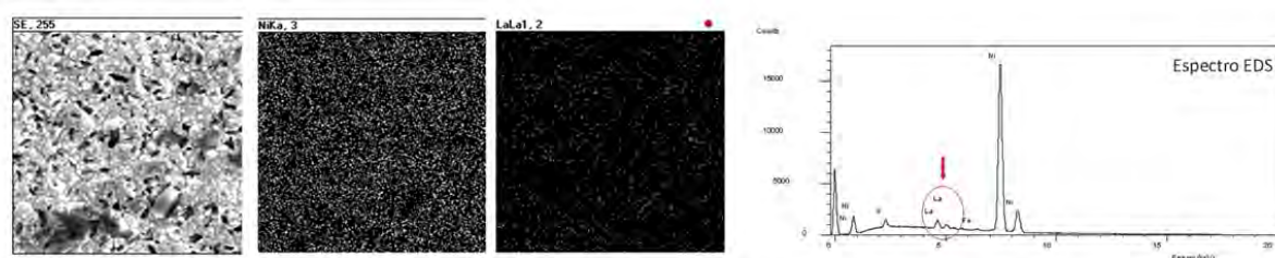
Eletrodeposição de Ni-La 2 O 3 sobre aço AISI 441 - Mapeamento do Ni (centro) e do La (direita), fotomicrografia MEV/SE (esquerda). Teor de La = 5%. MEV, 2000x
