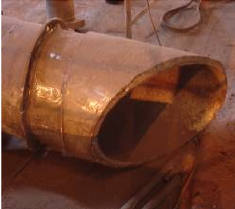
Figura 4. Chute novo, extremidade reformada, utilizando aço AISI 310.
