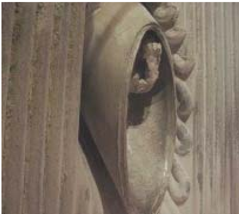
Figura 5. Chute novo, extremidade reformada, utilizando aço AISI 310.
