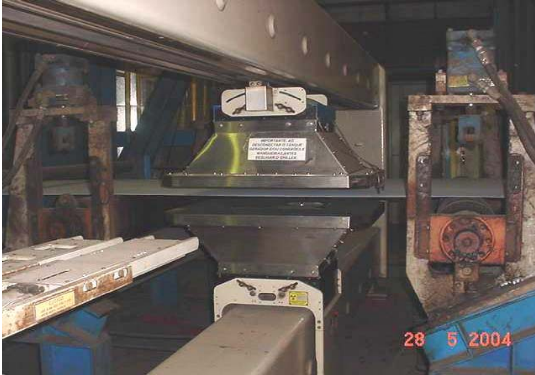
Figura 2. Medidor de revestimento TAYLOR / ABB da linha de zincagem nº2
