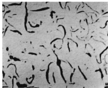
Figura 2 – Experiência 1 mat. sem ataque 100x
