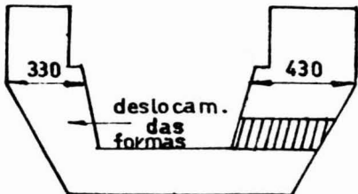
FIG. 7: AUMENTO NA ESP. DA PAREDE PRÓXIMA AO DRENO PELO DESLOCAMENTO, EM CERCA DE 50 mm , DAS FORMAS DE CONFECÇÃO.
