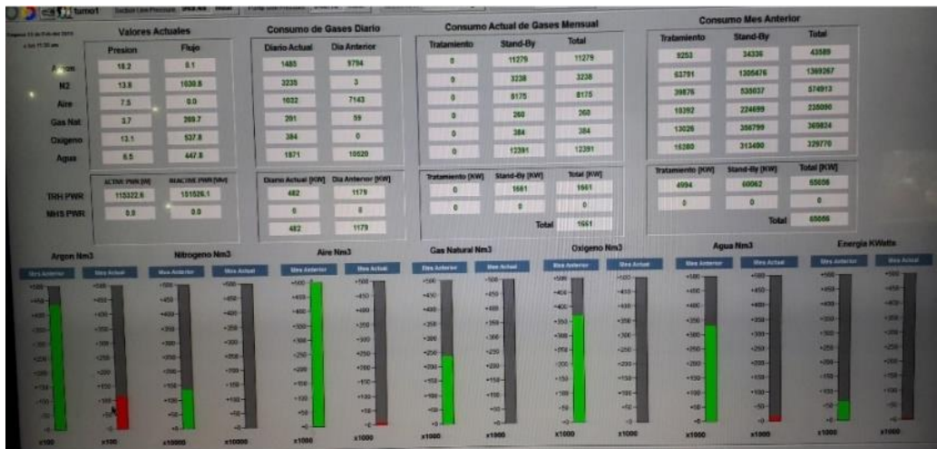
Figura 15: Tela de Nível 1 para controle diário e mensal de consumo dos gases e energia
