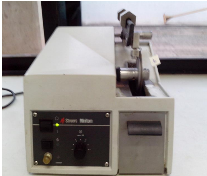
Figura 1 : Minitom utilizado para cortar as capsulas utilizadas no ensaio de pullout.
