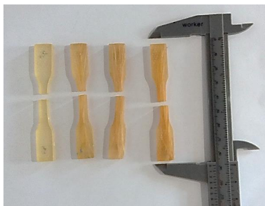
Figura 3. Aspecto macroscópico da fratura dos compósitos ensaiados em tração.
