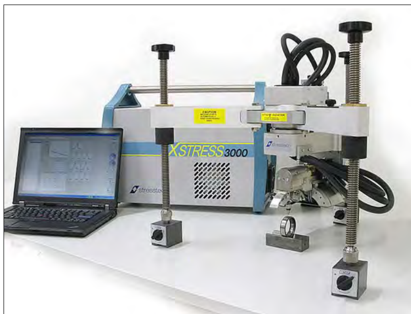
Figura 1. Difratômetro de raios-X portátil para medição de tensões residuais Stresstech modelo Xstress 3000 G2R.
