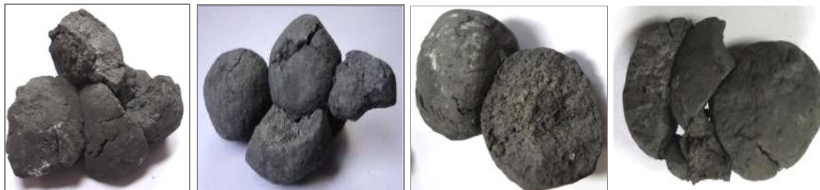
Figura 6. Colagem entre pelotas e cacos representando degradação por manuseio/transporte.
