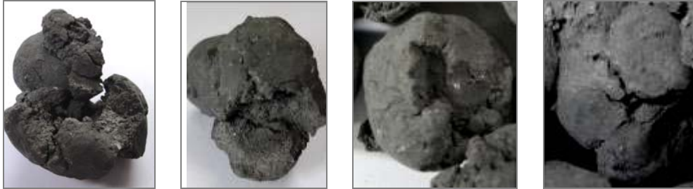
Figura 5. Pelotas degradadas durante o processo de redução direta.
