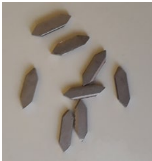
Figura 4. Geometrias das amostras empregadas nos ensaios de dilatométrica.
