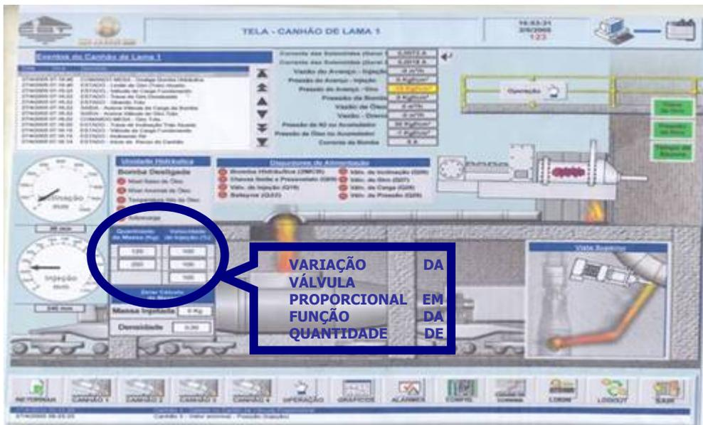
Figura 9. Tela do supervisor (tela de configuração da velocidade)
