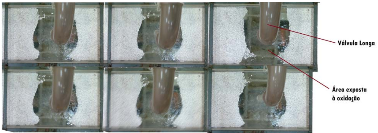
Figura 8. Vista superior da região do jato da panela no distribuidor.
