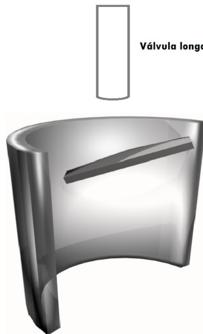
Figura 9. Vista interna da configuração de uma aleta para a indução do movimento espiralado na câmara de rotação.
