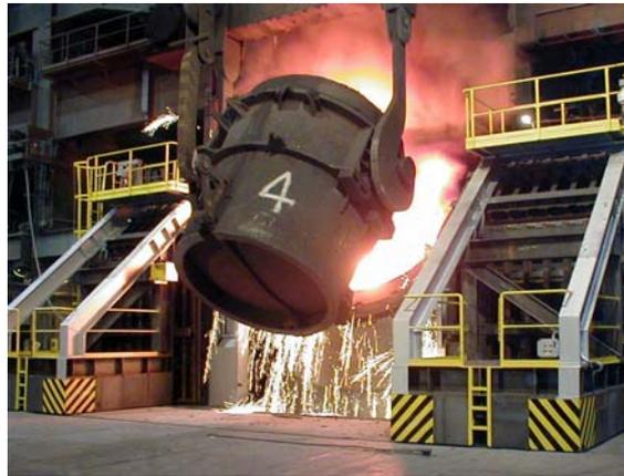
**Figura 1** – Foto ilustrativa de uma panela de aço líquida manuseada por ponte rolante
