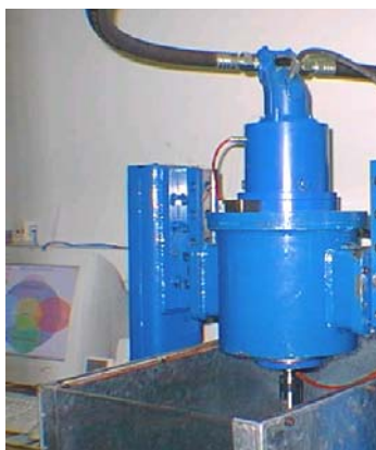
Figura 1. Unidade de Processamento de Pino por Atrito – UPPA.
