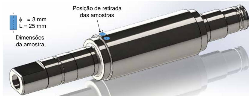
Figura 1. Dimensões da amostra para ensaio de desgaste e posição no cilindro de onde a amostra foi retirada.
