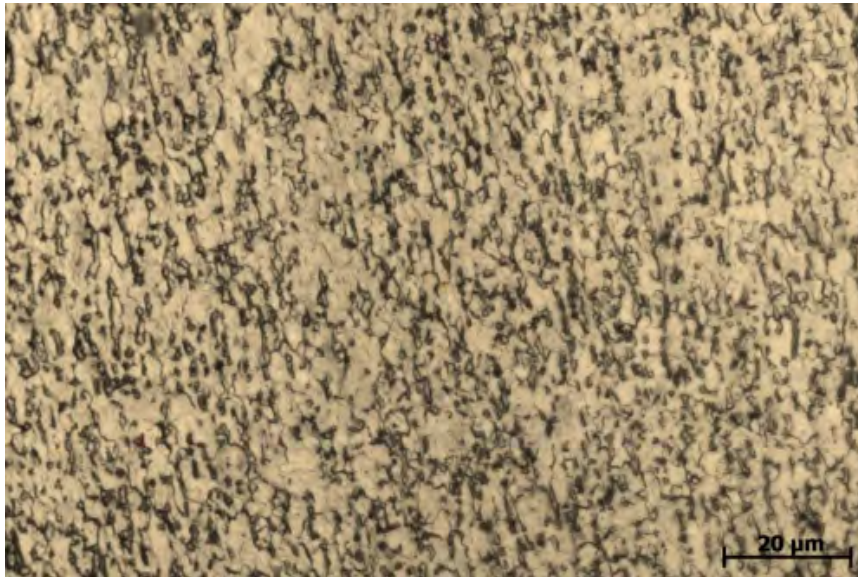
Figura 2. Microestrutura da liga Ti6Al4V composta por grãos refinados das fases \alpha e \beta .
