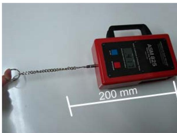
**Figura 5.** Equipamento para determinação do coeficiente de atrito dos pisos.
