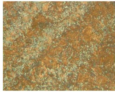
**Figura 4** – Fotomicrografia da amostra austenitizada a 850°C por 10 minutos e austemperada a 400°C por 5 minutos. Ataque: Bandoh.
