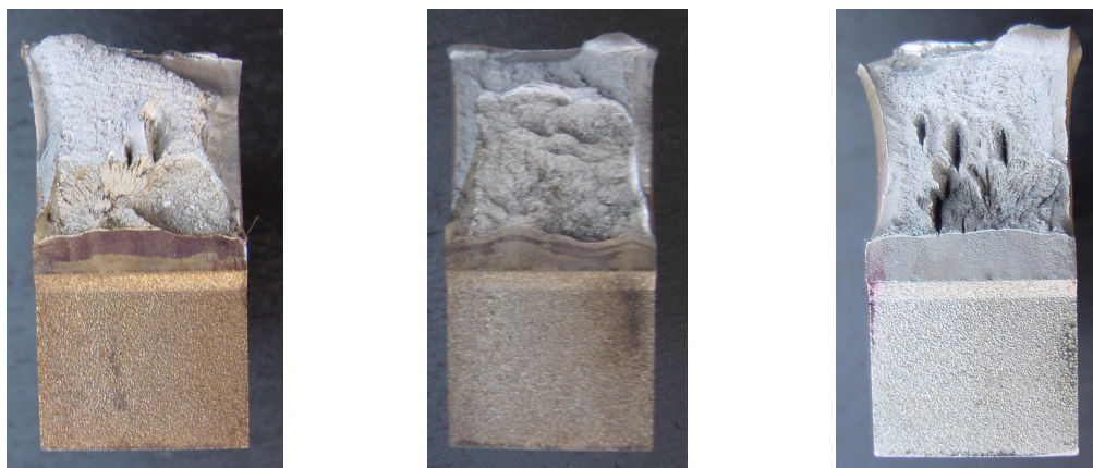
Figura 4: Corpos-de-prova com entalhe na ZTA após ensaio de CTOD e rasgamento para medição da pré-trinca: a) Z09 ensaiado a -40^{\circ}\text{C} ; b) Z10 ensaiado a -40^{\circ}\text{C} ; c) Z23 ensaiado a -70^{\circ}\text{C} .
