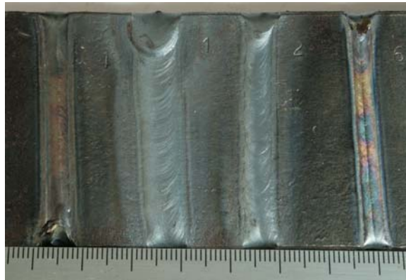
Figura 4. Cordões de solda realizados em uma das amostras. Velocidades (energias de soldagem) usadas da esquerda para a direita: 40, 10, 20 e 60 cm/min (3,6 kJ/cm; 14,4 kJ/cm; 7,2 kJ/cm e 2,4 kJ/cm).
