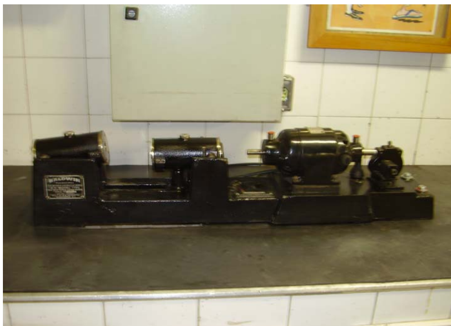
Figura 1. Máquina flexo-rotativa para execução dos ensaios de fadiga, equipamento pertencente ao Instituto Tecnológico de Aeronáutica.
