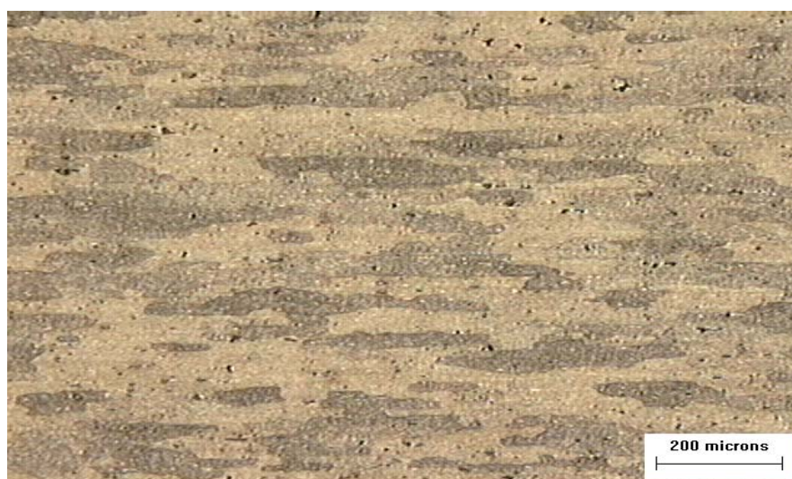
Figura 2. Micrografia da liga de alumínio 2024 solubilizada a 495°C por 1 h e resfriada em água.
