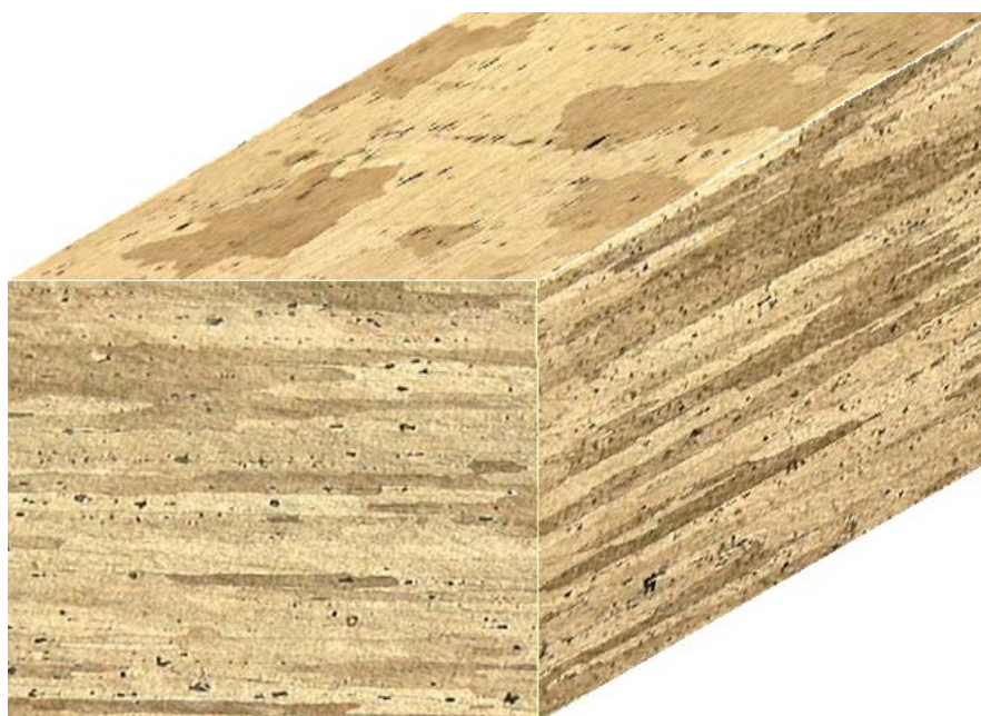
Figura 3. Imagem metalográfica tridimensional de uma amostra da chapa da liga de alumínio 2024 solubilizada a 505°C e envelhecida a 208°C/2h.
