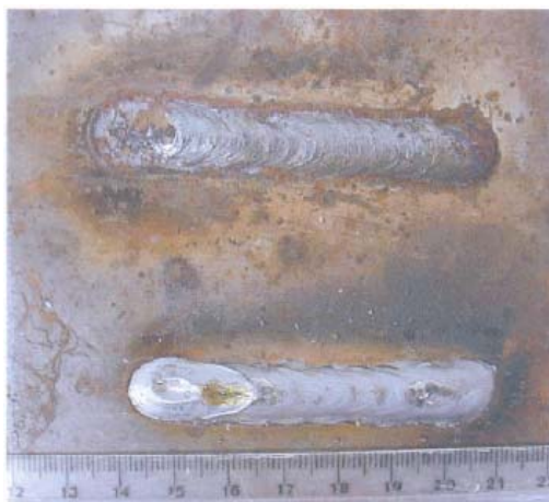
Figura 1 - Foto dos cordões de solda simulando a operação de ponteamto sobre o aço ASTM A516 grau 70.
