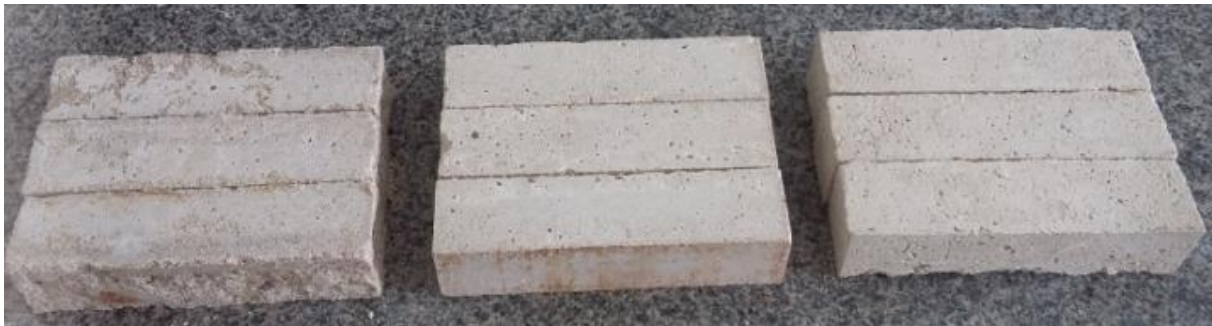
Figura 1. Corpos de prova de 0%, 25% e 50% de resíduo de granito
