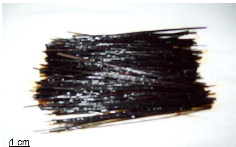
Figura 2: Mecha de fibra de Piaçava com tratamento de 0,1% de NaOH a 1 minuto.
