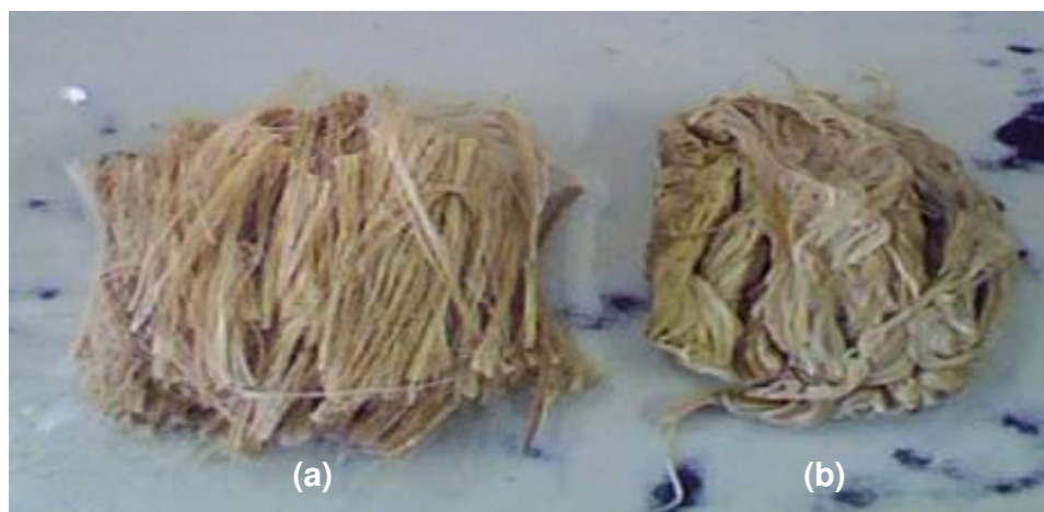
Figura 2. Mechas de fibra de Curauá: (a) sem tratamento (b) com tratamento NaOH 10% por 1 hora.
