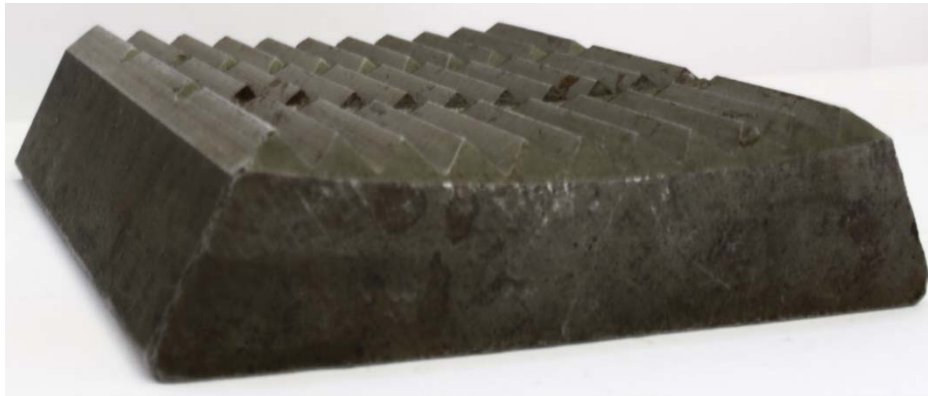
Figura 2: Mordente em estudo. Consiste em uma chapa com base plana que encaixa no sistema de pressão, além de uma superfície oposta composta de dentes que servem para agarrar o duto.
