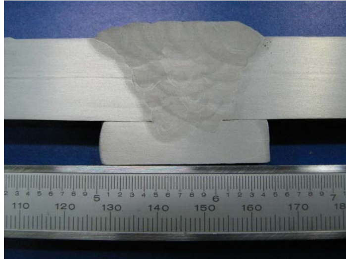
Figura 6. Aspecto macrográfico da junta soldada.
