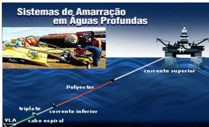
Figura 1. Esquema de sistema de ancoragem de plataforma semi-submersível. (1)
